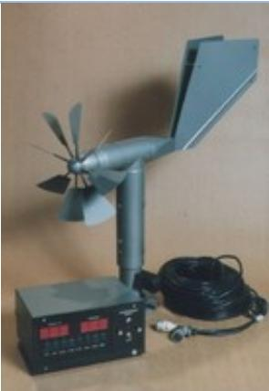
Предназначен для дистанционного измерения мгновенной, максимальной и средней скоростей и направления ветра в стационарных условиях. В состав прибора входит датчик ветра и пульт.
