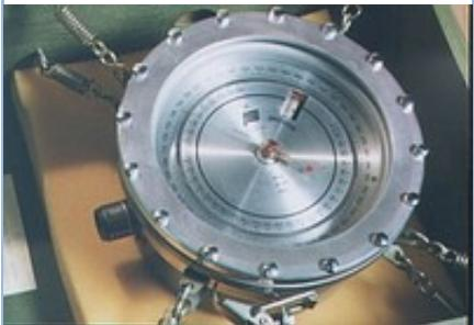
Предназначен для измерения атмосферного и абсолютного давления воздуха в испытываемом объеме при температуре от +5 до +500С и относительной влажности воздуха до 80%. Рабочее положение прибора — горизонтальное, шкалой вверх.
