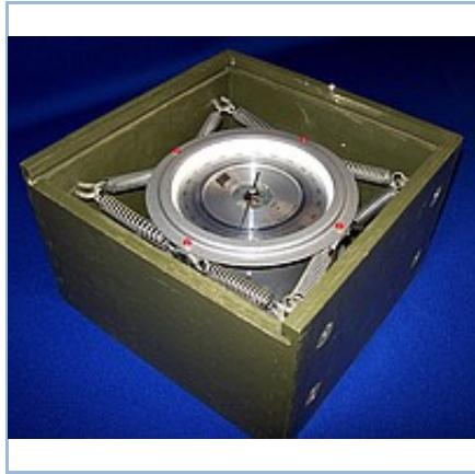
Предназначен для измерения атмосферного давления в наземных условиях для работы в помещениях при температуре от -10 до +50 0С и относительной влажности воздуха до 80%.
