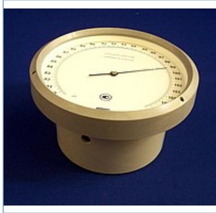
Предназначен для измерения атмосферного давления в наземных условиях при температуре от 0 до +40 0С и относительной влажности воздуха до 80%.
