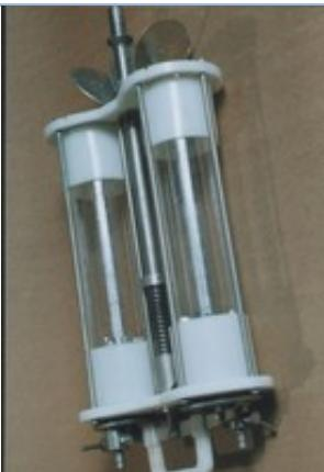
Предназначен для взятия проб воды с различных глубин водоемов, с одновременным измерением температуры воды исследуемого слоя при температуре окружающей среды от 1 до 40 0С.
