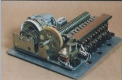
Прибор командный электропневматический предназначен для регулирования продолжительности и последовательности различных технологических процессов по заданной программе управления.
