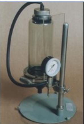
Предназначен для ускоренного фильтрования проб воды при определении ее мутности в лабораторных и полевых условиях. Прибор эксплуатируется при температуре от 5 до 40 0С и относительной влажности воздуха до 80%. Допускаемое рабочее давление в баллоне не более 3 кгс/кв. см2.
