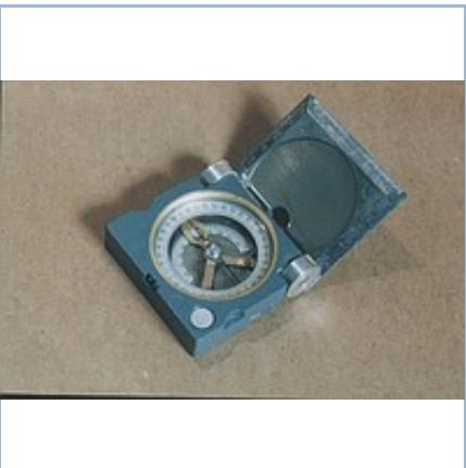
Компас горно-геологический ГГК предназначен для ориентировочного определения элементов залегания выходов пластов горных пород, ориентирования на местности, проложения съемочных маршрутов, визирования и других работ в полевых условиях.
