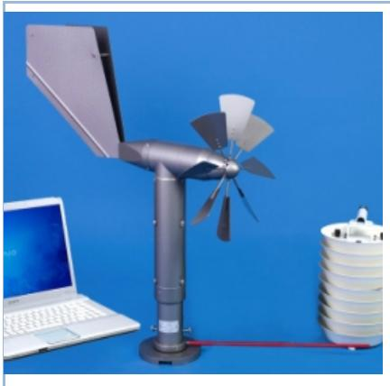
Метеостанция М-49М с компьютерным метеоадаптером предназначена для дистанционного измерения скорости и направления ветра, атмосферного давления, температуры и относительной влажности воздуха, выдачи и сохранения результатов измерения на компьютер через интерфейс RS-232.
