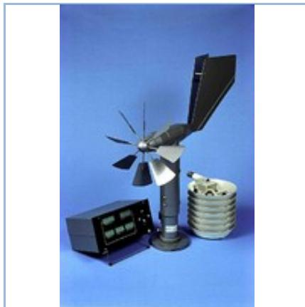
Предназначена для дистанционного измерения скорости и направления ветра, атмосферного давления, температуры и относительной влажности воздуха и выдачи результатов измерения на компьютер. В состав метеостанции входит датчик ветра, датчик влажности, пульт с цифровой индикацией, соединительные кабели и блок питания, позволяющий работать от сети переменного тока напряжением 220 В. ТЕХНИЧЕСКИЕ ХАРАКТЕРИСТИКИ
