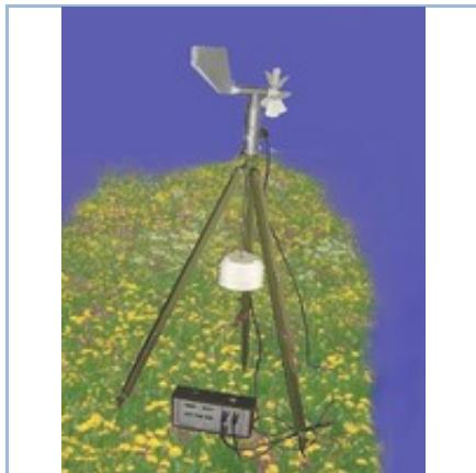
Представляет собой вариант исполнения метеостанции, предназначенный для мобильного развертывания в «полевых условиях», а также может быть установлен на передвиж
