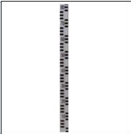
Рейка снегомерная переносная М-104М предназначена для измерения высоты снежного покрова. Представляет собой деревянный прямоугольный брускок с нанесенными краской делениями (штрихами) и оцифровкой. Нижний конец рейки совпадает с нулевым делением шкалы.
