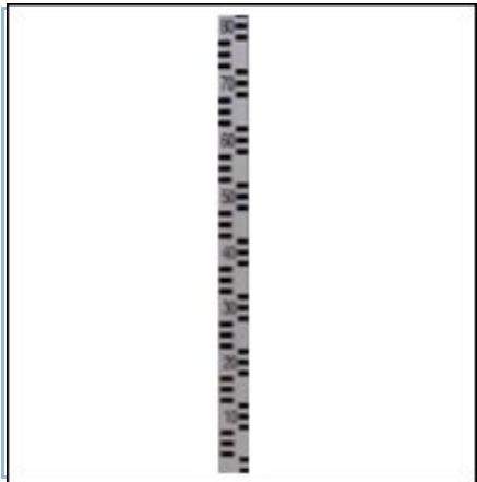
Рейка снегомерная деревянная М-103М-1 предназначена для стационарных измерений высоты снежного покрова. В зависимости от высоты снежного покрова изготавливаются рейки двух типов:
