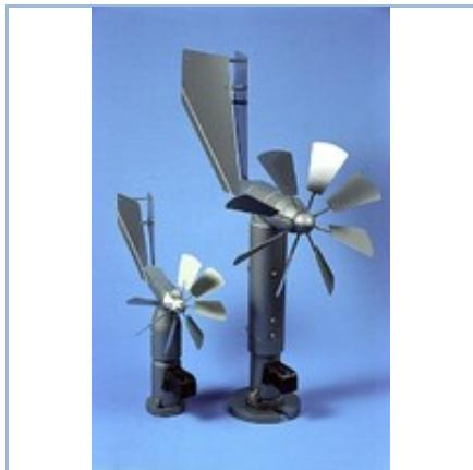
Предназначен для преобразования скорости и направления ветра в частоту и фазовый сдвиг электрических импульсов и для измерений скорости и направления ветра в составе систем сбора метеорологической информации и других систем телеметрических измерений, как в стационарных условиях, так и на передвижных объектах в составе анеморумбометра М63М-1, анеморумбографа М63МР, метеостанции М-49М.
