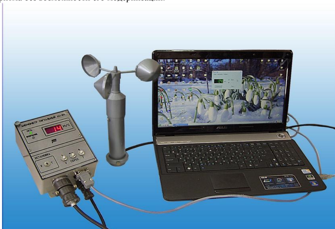
Рисунок 1- Общий вид анемометра сигнального АС-1 с интерфейсом RS 232 (с выходом на ПК)
